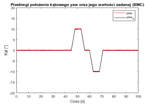
Rys. 15. Przebiegi położenia kąowego yaw oraz wartości zadanej (SMC, wzmocnienie zakłócenia – 1, opóźnienie pomiaru – 0,001 s).
