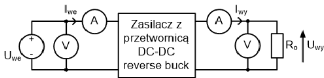
Rys. 2. Układ pomiarowy zasilacza z przetwornicą reverse buck
