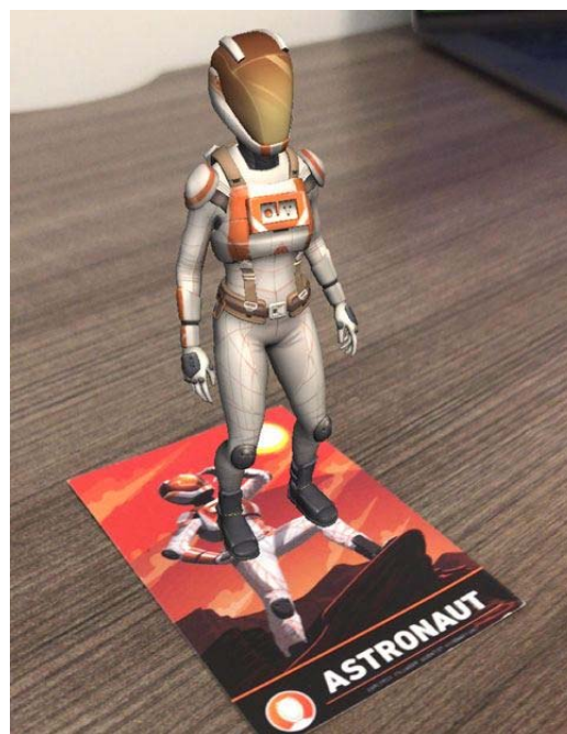
Rys.1. Przykład aplikacji wykorzystującej AR ze znacznikiem w formie dwuwymiarowej grafiki [13]
