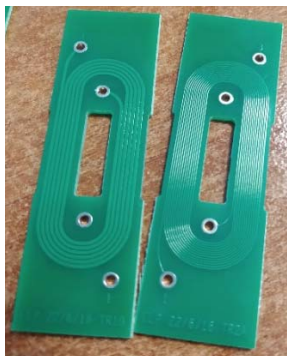
Rys. 2. Widok płytek tworzących uzwojenia transformatora
