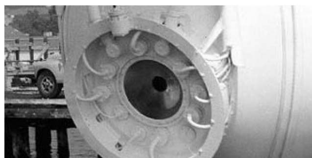
Rys. 5. Przykład wykorzystania szkła poliwęglanowego - okna batyskafu Trieste.
