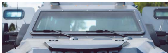
Rys. 4. Przykład użycia szkła pancernego jako szyby w pojeździe opancerzonym.
