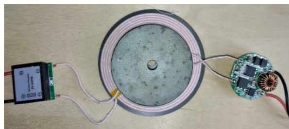
Rys. 14. Moduł ładowania bezprzewodowego TX24VHS
