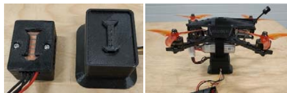
Rys. 13. Stanowisko do przewodowego ładowania akumulatorów w BSP.
