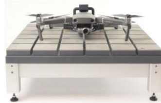
Rys. 6. Stykowy system ładowania BSP [21].
