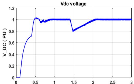
(c) (d) Fig.5. Simulation results of AC fault at rectifier side.
