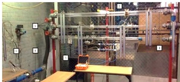
Rys. 3. Zdjęcie stanowiska pomiarowego: 1- przewód poziomy, 2- kryza ISA z przytarczowym pomiarem różnicy ciśnień, 3 - zawory regulacyjne, 4- przewód dolotowy, 5 - rejestrator ciśnień RPP-04, 6- manometr różnicowy
