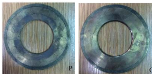
Rys.5. Kryza badana a) montaż kryzy b) obraz kryzy w ustawieniu: P- prawidłowym, O- odwrotnym
