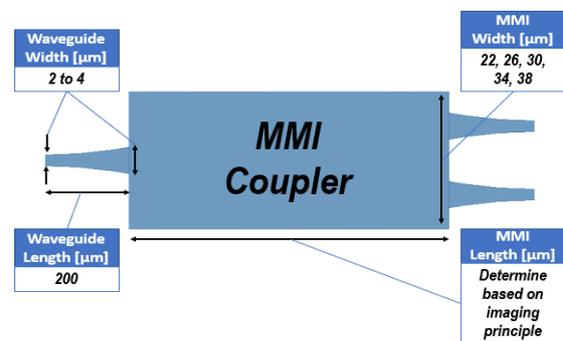
Fig. 6: Design parameter of 1x2 MMI Coupler
