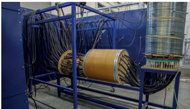
Rys. 5. Generator prądu udarowego (piorunowego) o kształcie 10/350 \mu s i wartości szczytowej do 100 kA, napięcie do 4 kV
