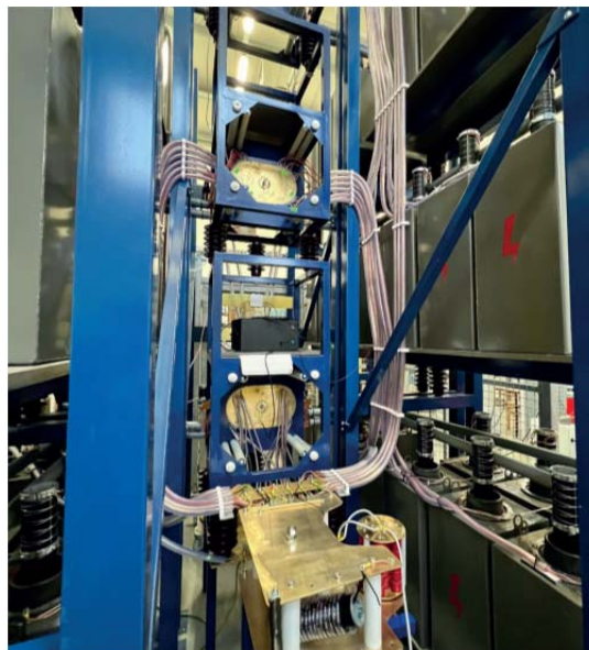
Rys. 6. Generator prądu udarowego (piorunowego) o kształcie 10/350 \mu s i wartości szczytowej do 200 kA, napięcie do 120 kV
