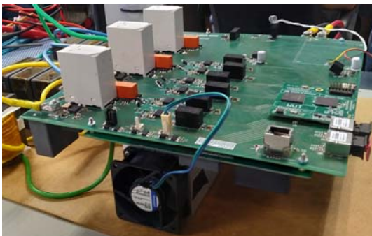
Rys.7. Prototyp 15 kW AFE z system chłodzenia: (a) wizualizacja 3D; (b) model eksperymentalny
