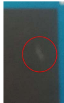
Rys. 10. Powiększenie obszaru z widocznym defektem powłoki.
