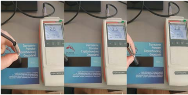
Rys. 7. Pomiar zawartości ferrytu w próbce A
