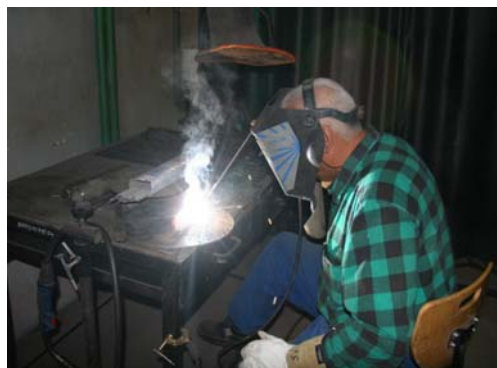
Rys. 6. Badane stanowisko spawania elektrycznego elektrodą otuloną (MMA)
