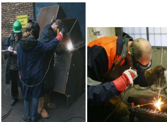
Rys. 1. Przykład pomiaru zagrożenia fotochemicznego oczu na stanowisku spawacza
