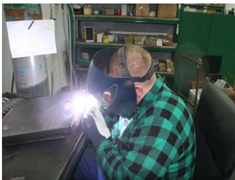
Rys. 3. Badane stanowisko spawania metodą TIG stali nierdzewnej
