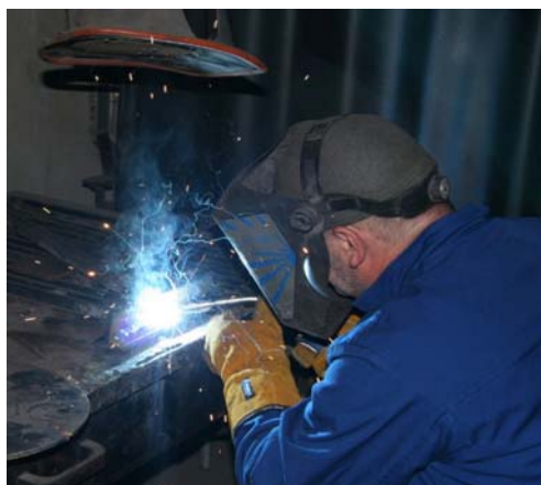
Rys. 5. Badane stanowisko spawania metodą MAG stali St3s
