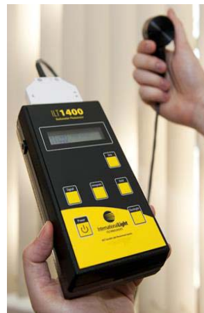
Rys. 2. Radiometr ILT 1400 wraz z sondą pomiarową
