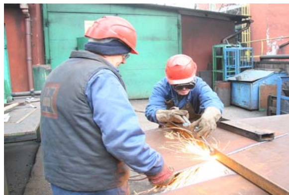
Rys. 8. Badane stanowisko cięcia acetylenowego
