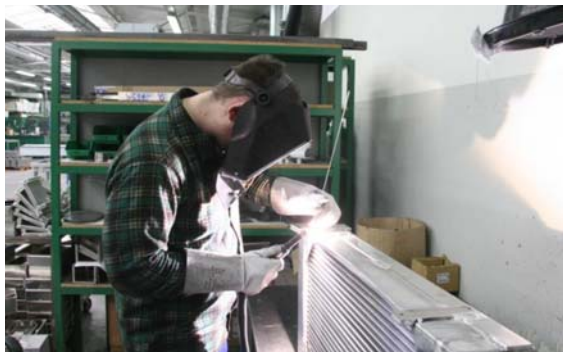
Rys. 4. Badane stanowisko spawania metodą TIG chłodnicy aluminiowej
