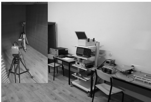
Rys. 2. Laboracyjne stanowisko do badania impulsowych pól EM
