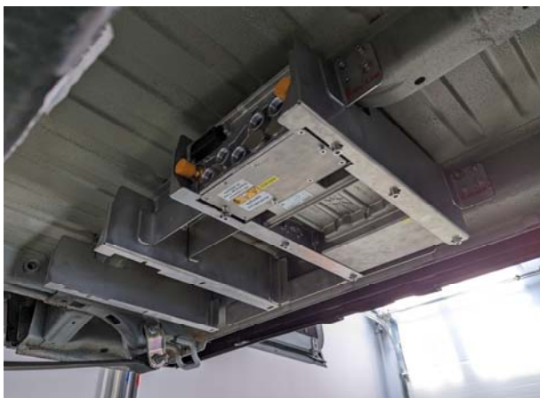
Rys.8. Widok mocowania falowników pod podwoziem (na zdjęciu widać zamontowany tylko jeden falownik)
