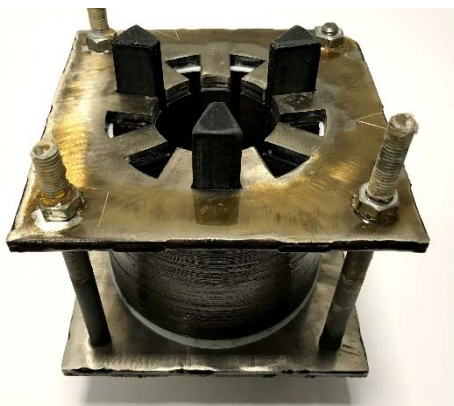
Rys.6. Pakietowany rdzeń silnika PM BLDC o wysokości 80mm
