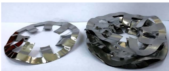
Rys.5. Odlana taśma amorficzna: a) rolka taśmy; b) pierścienie rdzenia silnika wycięte z taśmy amorficznej
