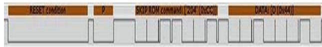
Rys.10. Przebiegi czasowe interfejsu 1-Wire przy zastosowaniu kondensatora i poprawnej detekcji ramek danych
