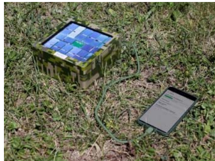
Rys. 8. Ładowarka słoneczna na bazie ogniw krzemowych i superkondensatorów w wersji wojskowej (kamuflażu) skonstruowana w WITI
