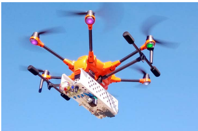
Rys. 3. Dron Yuneec H520E podczas lotu testowego z podłączonym urządzeniem pomiarowym
