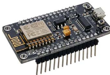
Rys. 3. Zestaw rozwojowy NodeMCU ESP8266, [15]
