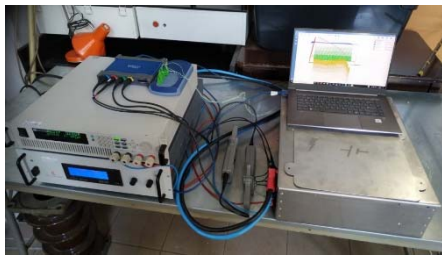
Rys.2. Schemat i zdjęcie stanowiska pomiarowego modułu EHES do testów obciążeniowych w warunkach laboratoryjnych
