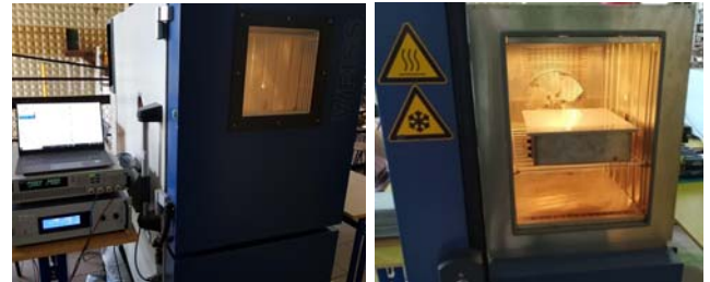
Rys.4. Schemat ideowy i zdjęcie stanowiska do badań termicznych modułu EHES oraz wnętrza komory z badanym urządzeniem
