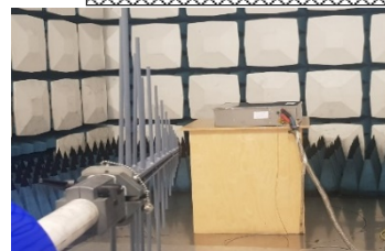
Rys.8. Schemat blokowy oraz zdjęcie stanowiska do pomiaru zaburzeń promieniowanych z modułu EHES (ładowanie EHES)
