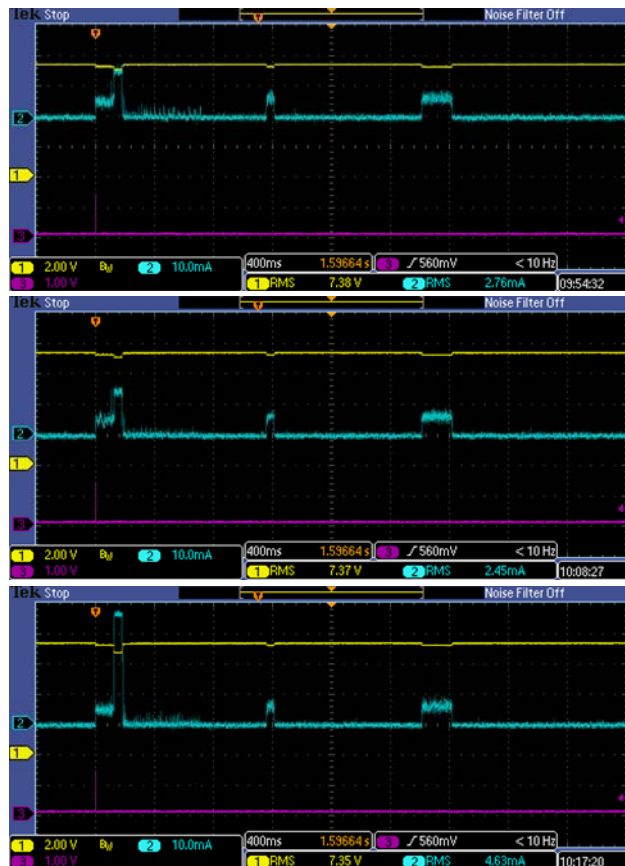
Rys. 10. Zmiany napięć VBAT i ADC_IN0 oraz prądu IBAT podczas cyklicznej pracy trzech platform zasilanych z baterii
