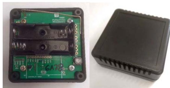
Rys. 7. Widok prototypu autonomicznej platformy czujnikowej z czujnikiem temperatury DS18B20 zabudowanej w obudowie Z123
