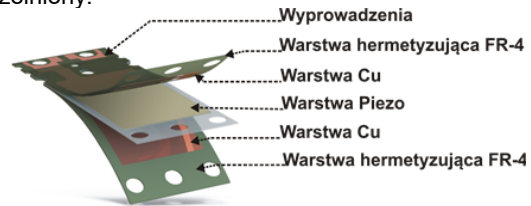
Rys.3. Warstwy w module generatora piezoelektrycznego firmy MIDE [26, 27].
