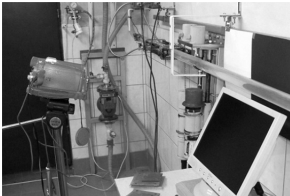
Rys. 2. Widok ogólny sekcji pomiarowej instalacji hydraulicznej do badania przepływów dwufazowych
