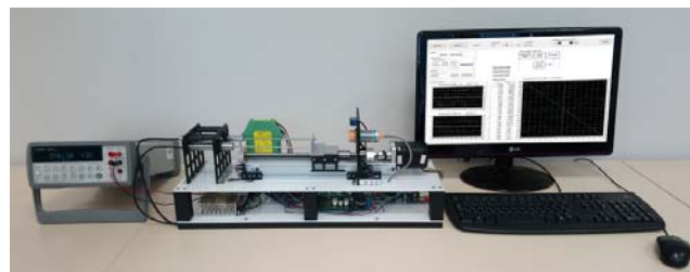
Rys.4. Widok systemu do badania sensorów przemieszczenia
