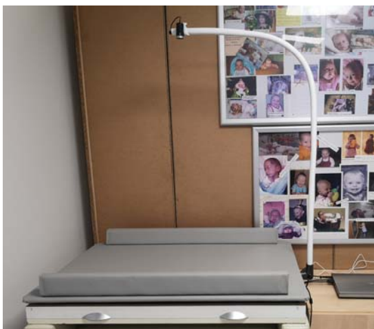
Rys.1. Stabilograficzne stanowisko do badania niemowląt
