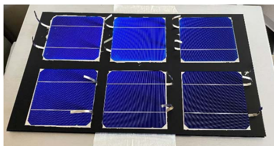
Rys. 3. Widok płyty anodowanej z nałożonymi ogniwami fotowoltaicznymi.
