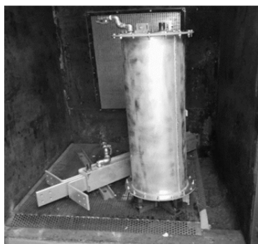
Rys.5. Modele szynoprzewodów do badań weryfikacyjnych
