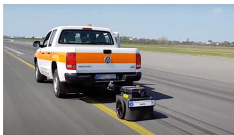
Rys. 1 Platforma pomiarowa do badania jakości działania lamp lotniskowych
