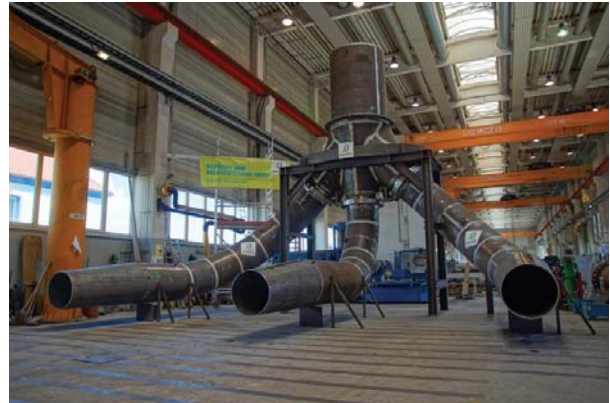
Rys.7. Rurociąg dystrybucyjny trifurcator z przejściem do trzech turbozespołów, Foto: [D]
