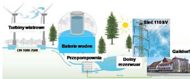
Rys.9. Szkic systemu wiatrowo-wodnego w Gaildorf. Opracowanie własne na podstawie [18]
