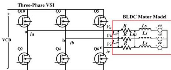
Fig. 1. BLDC Motor System.
