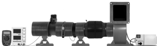
Rys. 5. Stanowisko badawcze dla przepływomierzy z klapą spiętrzającą, HLM, HFM oraz Vortex
