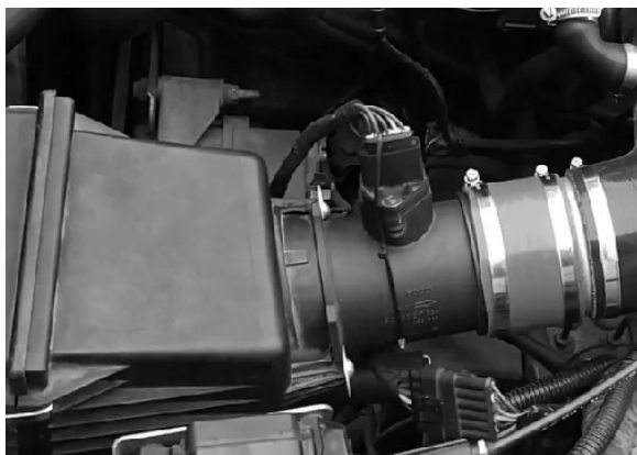
Rys. 7. Sposób zamocowania przepływomierza typu HFM w samochodzie marki BMW E-30 (fot. autorów)
