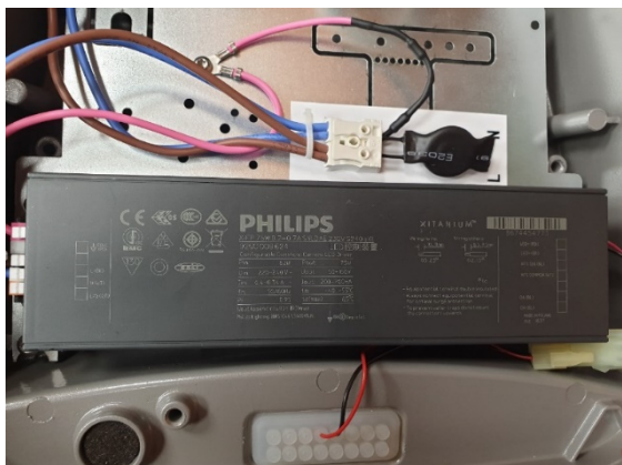
Rys. 1. Widok zasilacza typu Xi FP SNLDAE zamontowanego w lampie ulicznej LED typu TECEO1
