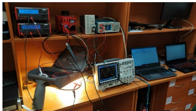
Rys. 3. Widok stanowiska do pomiaru parametrów eksploatacyjnych zasilacza lampy ulicznej LED
