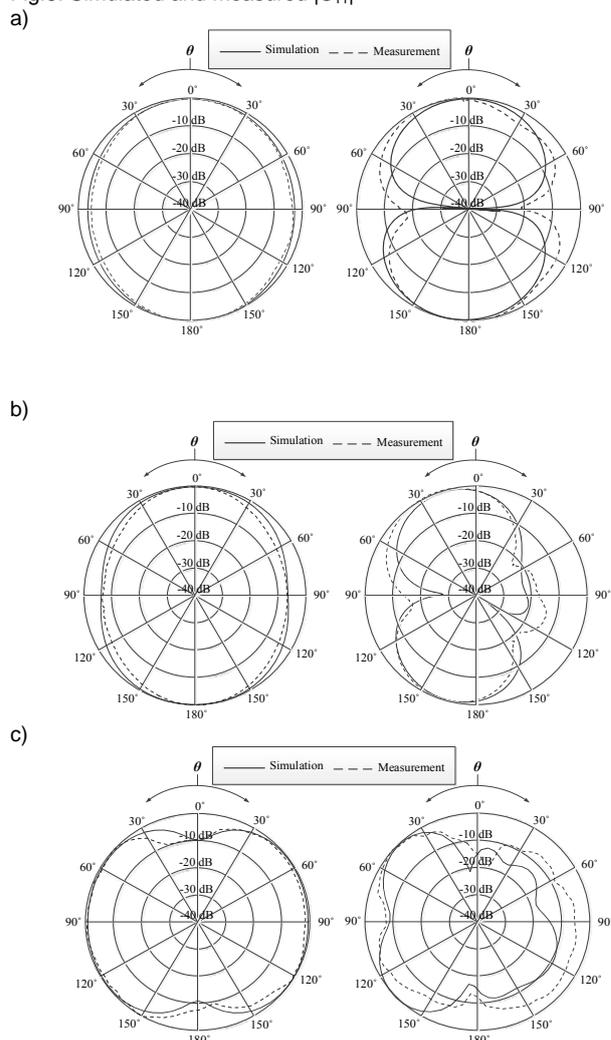
Fig.9. Radiation pattern in  $xz$ - and  $yz$ -planes at: a) 3.1 GHz b) 6 GHz c) 10.6 GHz
