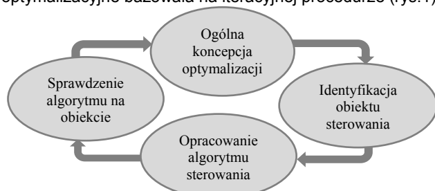
Rys.1. Iteracyjna procedura optymalizacji układu sterowania
