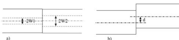
Rys. 2. Źródła strat w termicznych połączeniach światłowodów jednomodowych: a) niedopasowanie promieni pól modowych światłowodów, b) przesunięcie osi światłowodów [7]
