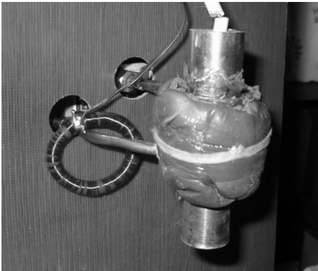
Rys.3 Cewka wzbudnika wykonanego z rurki miedzianej, z otuliną wykonaną z materiału firmy Fluxtrol, z rurą nieferromagnetyczną we wnętrzu.
