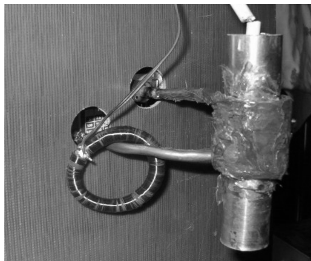
Rys.2. Cewka wzbudnika wykonanego z rurki miedzianej bez otuliny, z rurą ze stali nieferromagnetycznej umieszczoną wewnątrz.
