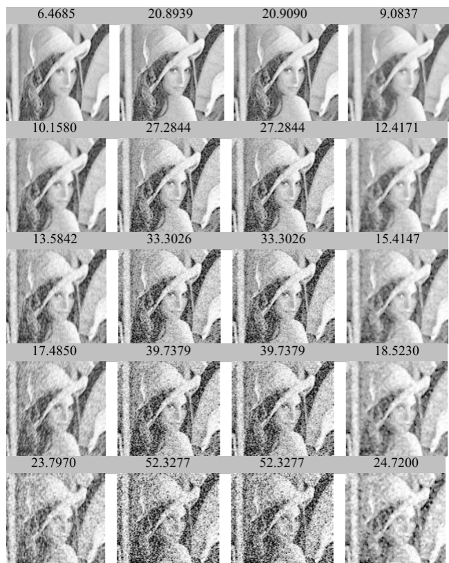
Rys. 7. Uzyskane obrazy po filtracji wybranymi filtrami. Od lewej strony kolejno: filtr uzyskany metodą CGPDFD, filtr minimum, filtr maksimum, filtr medianowy (1 wiersz – szum 5%, 2 wiersz – szum 10%, 3 wiersz – szum 15%, 4 wiersz – szum 20%, 5 wiersz – szum 30%)
