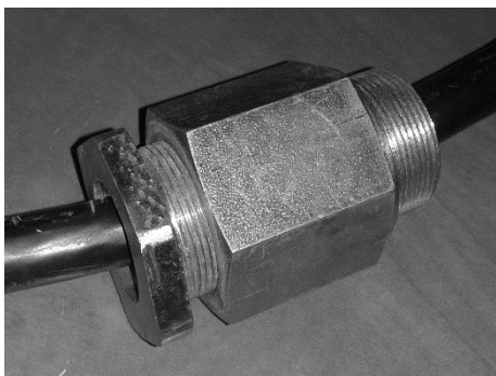
Rys.1. Wpust kablowy W1 – materiał ferromagnetyczny
