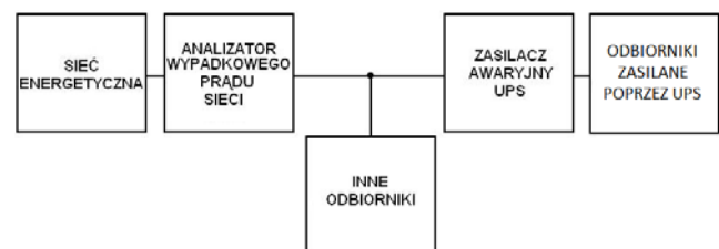
Rys.1. Uproszczony schemat blokowy systemu elektrycznego z zasilaczem UPS, współpracującym z innymi odbiornikami energii elektrycznej
