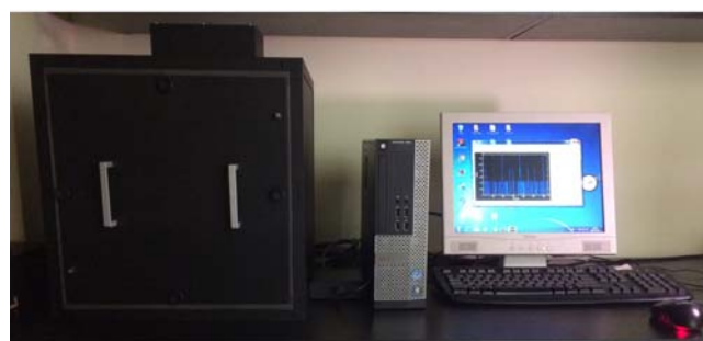
Rys. 1. Prototypowy układ pomiarowy umożliwiający rejestrację liczby fotonów emitowanych z produktów spożywczych, po lewej – komora pomiarowa
