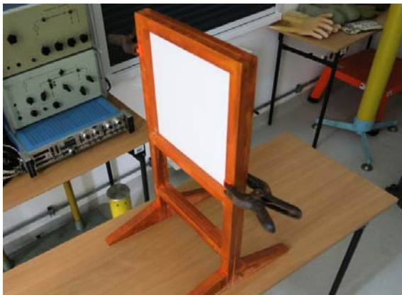
Rys.6. Ogólny widok układu mocującego z umieszczoną przegrodą
