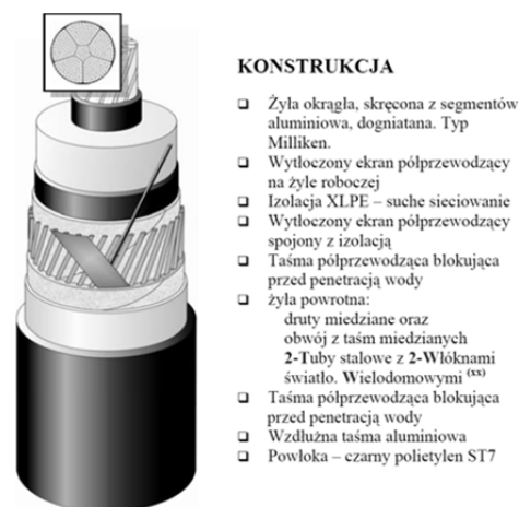
Rys.1. Konstrukcja badanego kabla A2XS(FL)2Y 1x2500 RMS/70 127/220/245kV
