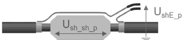
Rys.8. Mufa separacyjna z widocznymi wyprowadzeniami i oznaczeniami badanych napięć [11]
