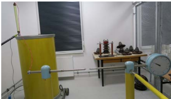
Rys. 2. Zdjęcie wysokonapięciowej celki pomiarowej, układu probierczego i iskiernika w którym mocowano elektrody ostrzowe o różnej geometrii
