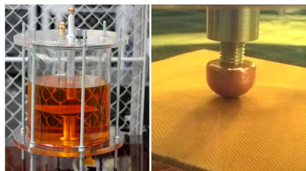
Rys.4. Zdjęcie komory badawczej wypełnionej olejem mineralnym (a) oraz układu elektrod do generacji wnz w klinie olejowym (b)
