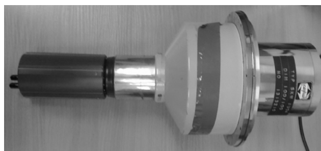
Rys.1. Sonda z kryształem studzienkowym NaI(Tl) SKW IUO4 (firmy TESLA) wykorzystywana do pomiaru zawartości K, U, Th w próbkach uzyskanych z rdzeni wiertniczych
