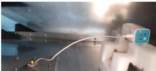
Rys.8. Power bank nr 3 wewnątrz komory GTEM w trakcie ładowania. Zasilanie na zewnątrz komory
