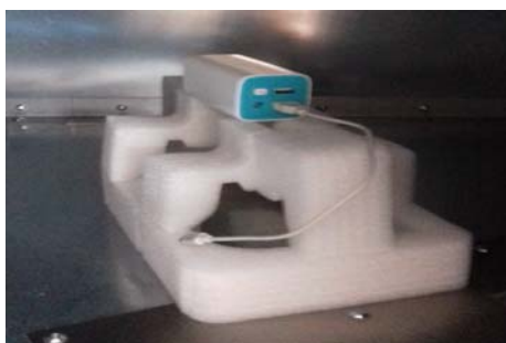
Rys.5. Wyłączony power bank nr 3 wewnątrz komory GTEM z podłączonym kablem USB
