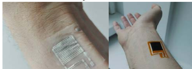
Rys.1. Czujnik rezystancyjny pulsu: (u góry) schemat budowy czujnika; (z lewej) warstwa przewodząca zamocowana na skórze; (z prawej) kompletny czujnik
