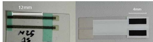
Rys.3. Wykonane techniką sitodruku czujniki elektrochemiczne: amperometryczny (z lewej) oraz dwa czujniki potencjometryczne (z prawej)
