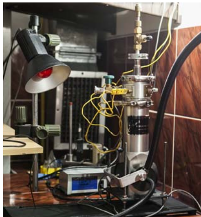
Rys.1. Kriostat optyczny z opcją wysokotemperaturową zastosowany do pomiarów SR-TL (Janis, USA)
