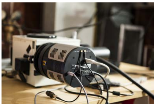
Rys.2. Kamera CCD chłodzona termoelektrycznie (Princeton Instruments, USA)
